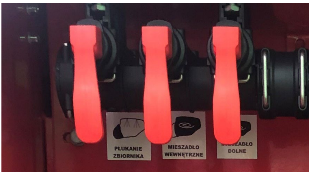
Rysunek 16. Manualne zawory sekcyjne.
