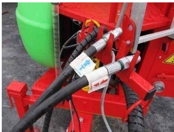
Rysunek 2. Przewody hydrauliczne umocowane prawidłowo.
