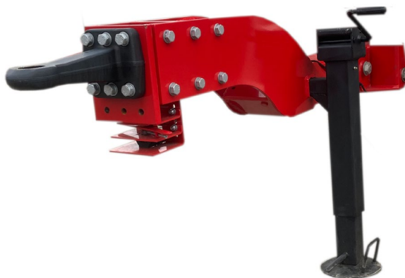
Rysunek 27. Pozycja postojowa wspornika mechanicznego dyszla
